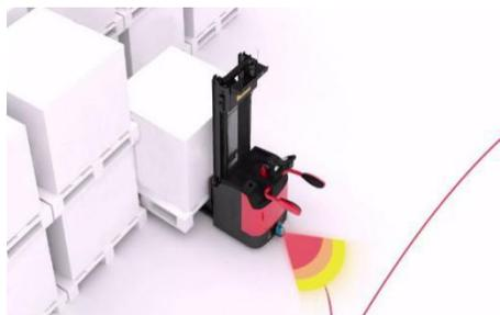
图 3 安全防护应用示例
